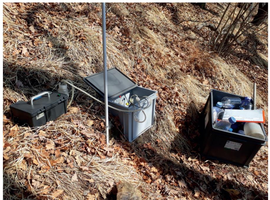
Abb. 5. Wechsel der Lysimeterflaschen und Anlegen des Unterdrucks zur Beprobung des Bodenwassers in der nächsten Sammelperiode auf der LWF-Fläche in Novaggio (Foto: P. Waldner, WSL).
