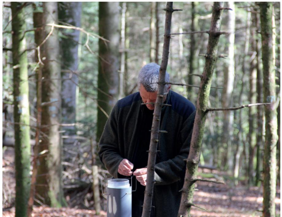
Abb. 2. Reparatur des Vogelschutzes an einem Bestandesniederschlagsammler auf der LWF-Fläche in Lausanne (Foto: Anne Thimonier, WSL).
