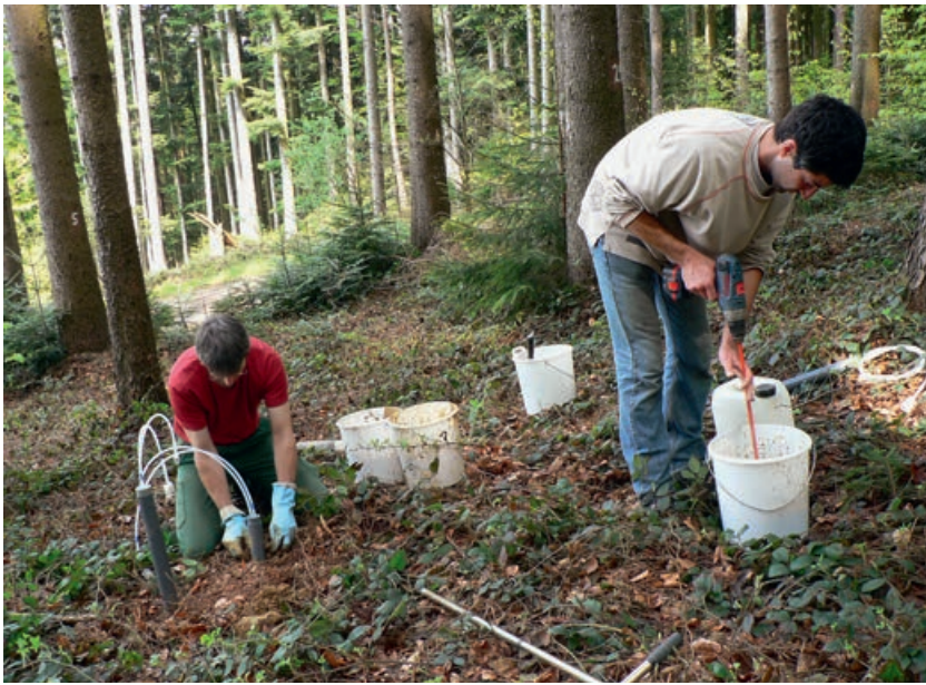
Abb 1 Setzen der Bodenwassersammler (Saugkerzen).
